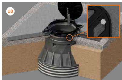
10 Kinnitada luuk nurkadest kiilankrutega.
