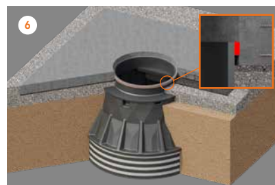
6 Paigaldada tihendusmass raudbetoonplaadi ja pumpla krae vahele.
