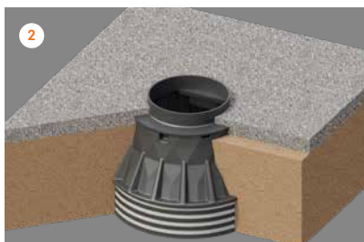
2 Lisada tihendatud killustikaluse kiht.
