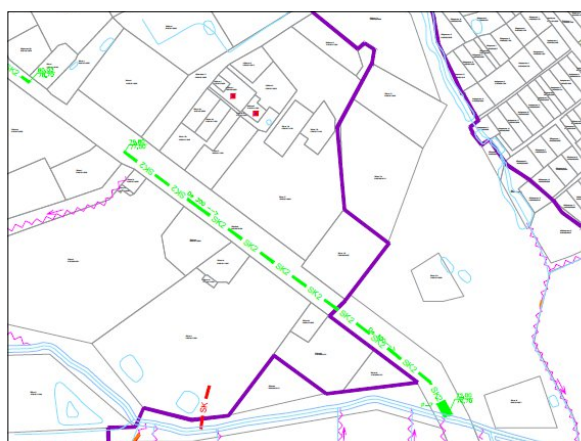
Skeem 3. Perspektiivne sademeveekanalisisatsioon Pikal tänaval (väljavõtte ÜVK arendamise kavast, 2019).
