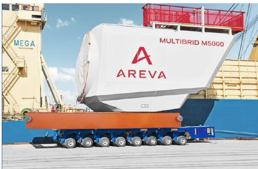
Joonis 23. Tuuliku gondel ja selle paigalduse ettevalmistus sadamas
