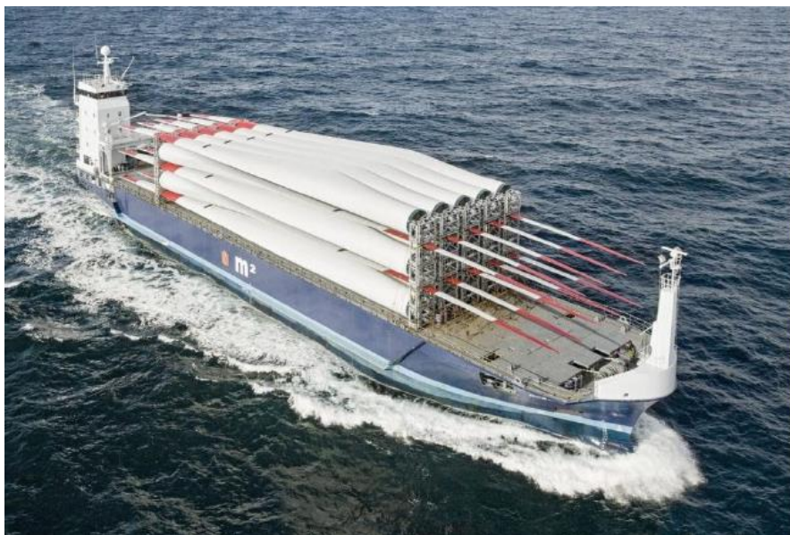
Joonis 26. Tuulikute labade transport merel tuulepargialale
