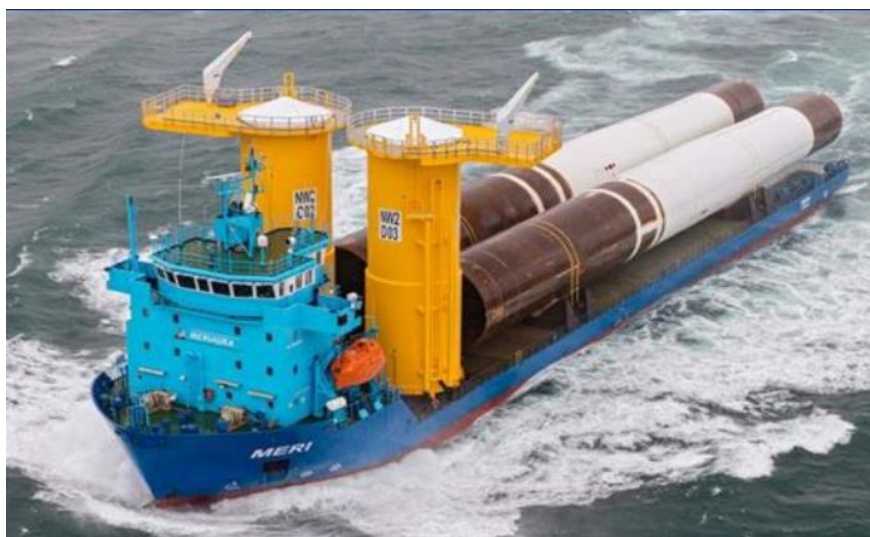
Joonis 25. Tuulikute elementide transport merel tuulepargialale
