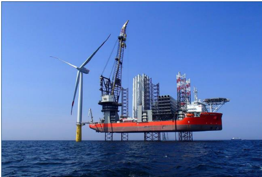
Joonis 31. Tuulikute paigaldusalus „töösendis“ tuulepargialal
