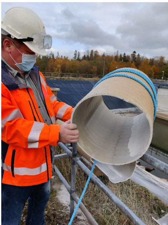
Foto 1. Sarnase GRP toru saagimine
