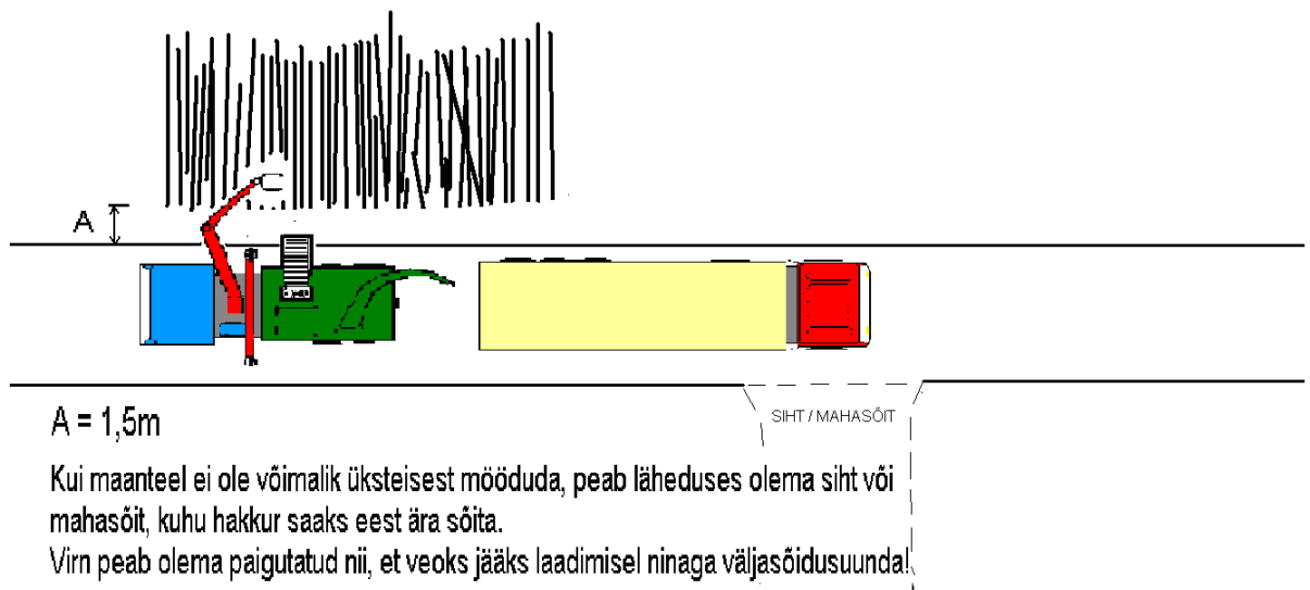
Joonis 1. Hakkimine, kui hakkur asub konteinerveoki taga
