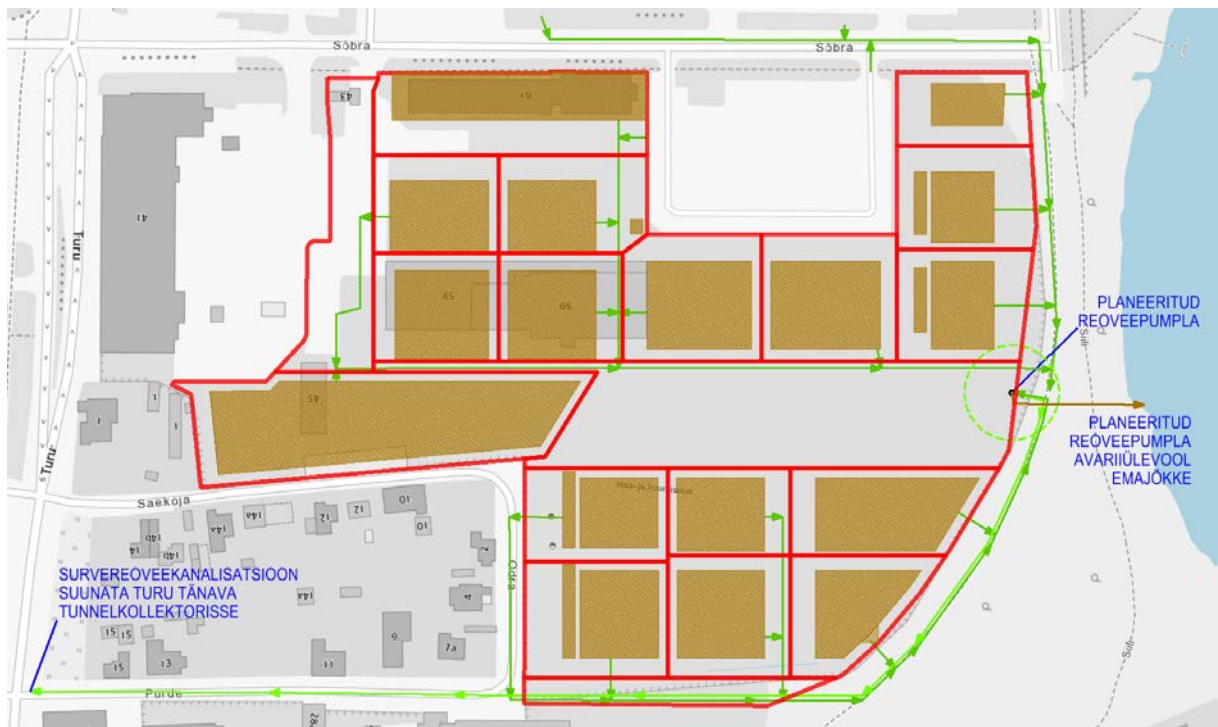
Skeem 4. Planeeritud reoveekanaliseerimise skeem. Tumeroheliste joonte ja nooltega on planeeritud isevooline reoveekanaliseerimine ning heleroheliste joonte ja nooltega survereoveekanaliseerimine.
