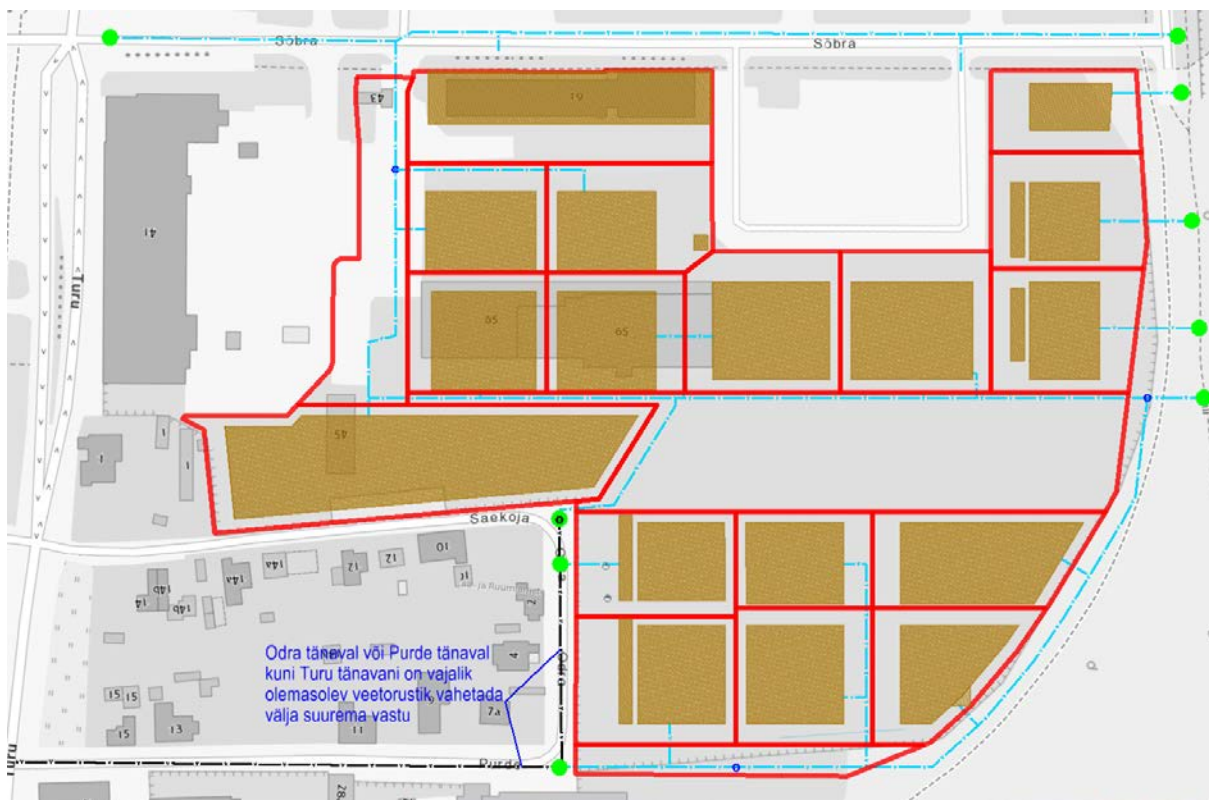
Skeem 3. Planeeritud veetorustike skeem. Rohelise ringiga on tähistatud ühenduskohad olemasolevate torustikega.
