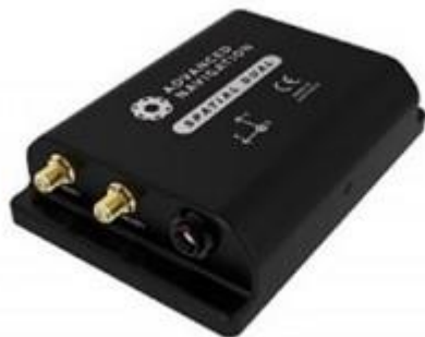
Pilt 2. Inertsiaal GPS süsteem Advanced Navigation Spatial Dual
