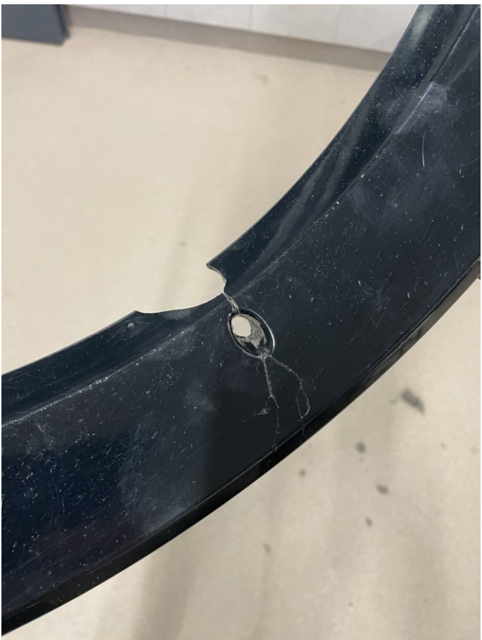
Paljudel kuivatitel olid purunenud trumlilabade plastikust otsad
