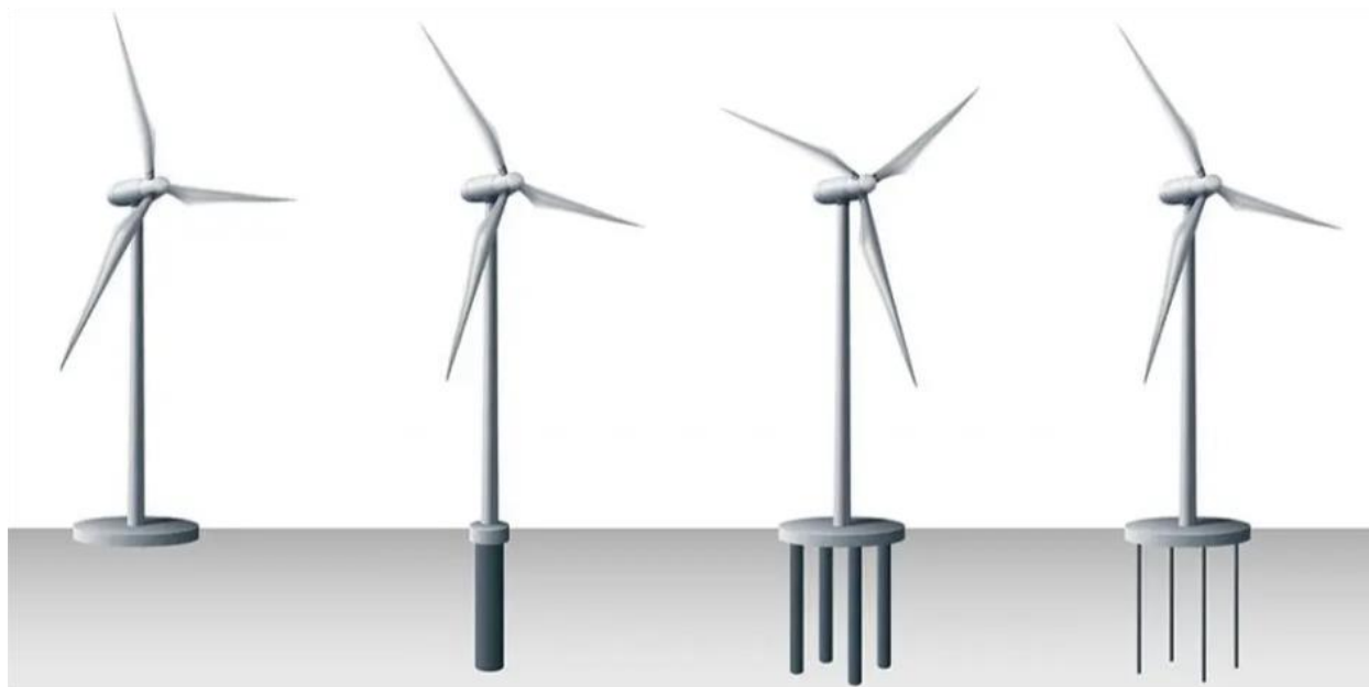
Joonis 2. Tuulikute vundamentide tüübid 4 .
