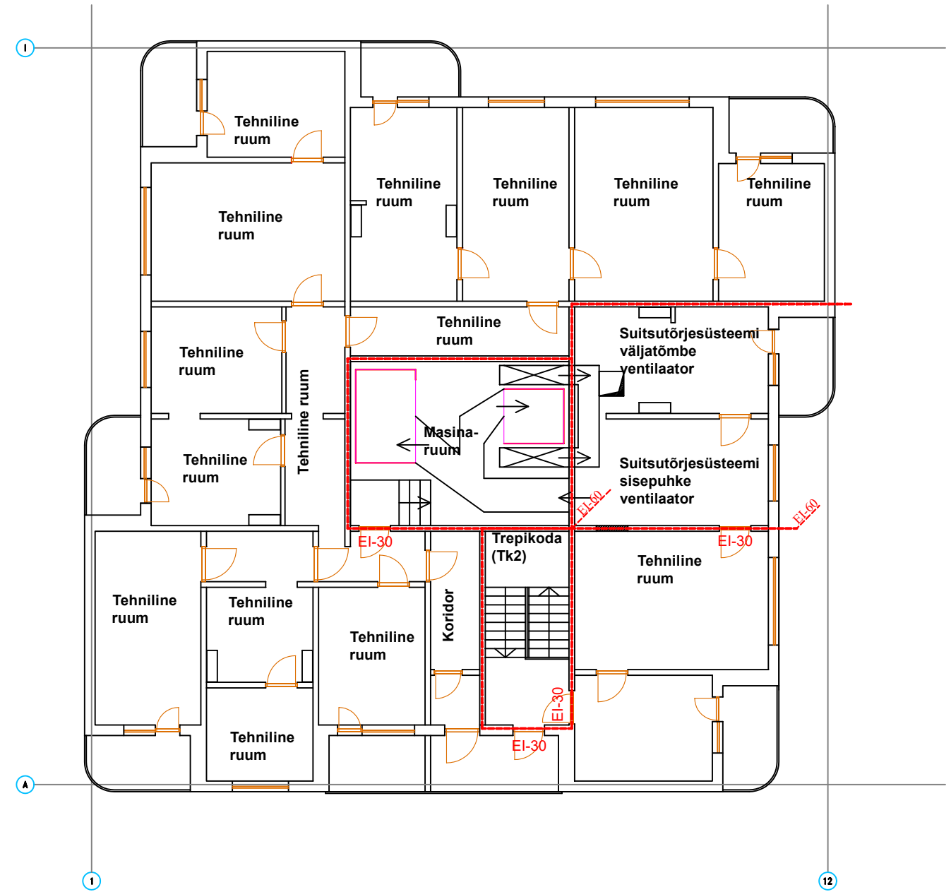
tehnilise korruse (17.) tuletõkkeseksioonid
