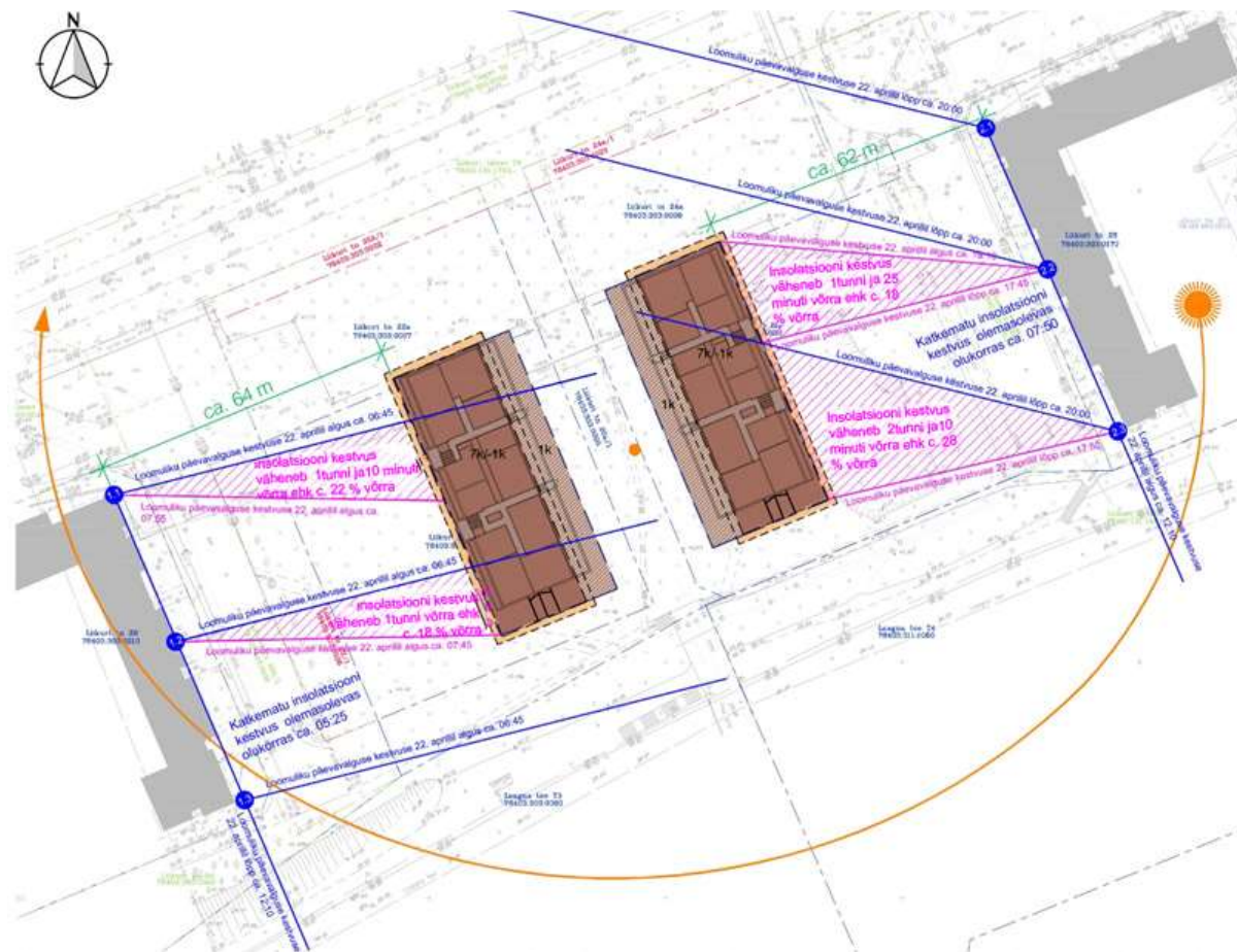
Skeem 1: Skemaatiline insolatsiooni analüüs naaber hoonetele – skeemil on markeeritud insolatsiooni olemasolevas olukorras sinisega ja planeeritavaid muudatusi magnetaga.
