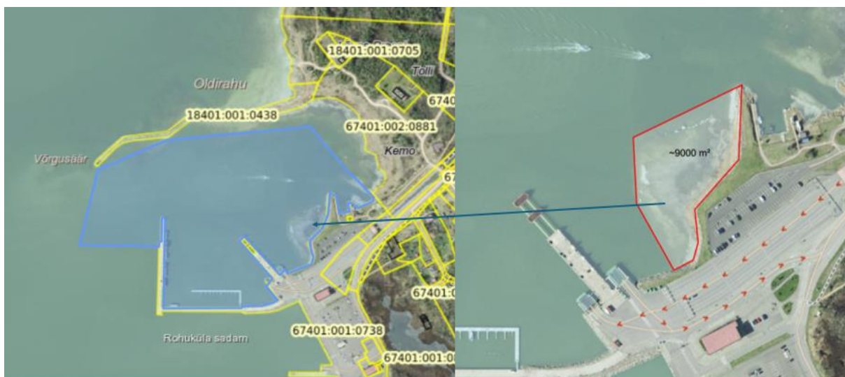
Joonis 1. Vasakul on sinisega märgitud vee erikasutuse ala, paremal on süvenduspinnase paigutamise ala.
