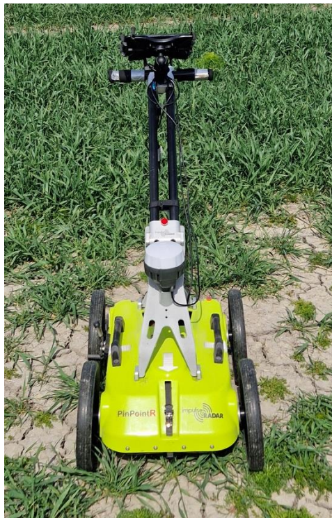
Joonis 1: Uuringus kasutatud georadar PinPointR koos Emlid RTK GNSS-ga
