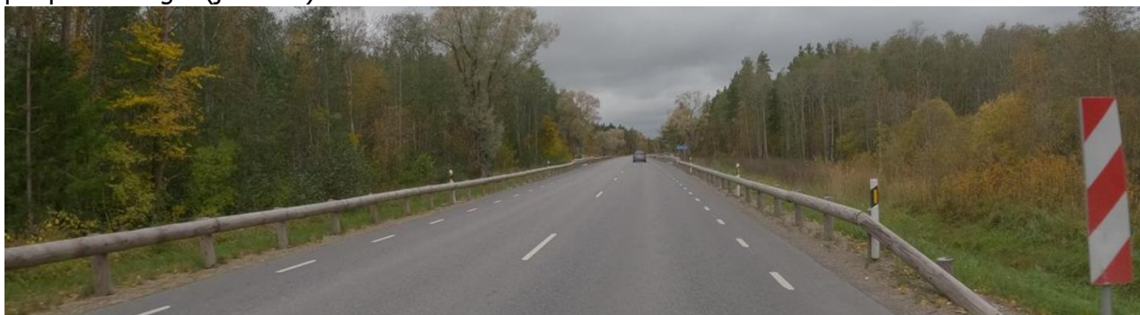
Joonis 5. Puitpaneelidega kaetud pörkepiire.
