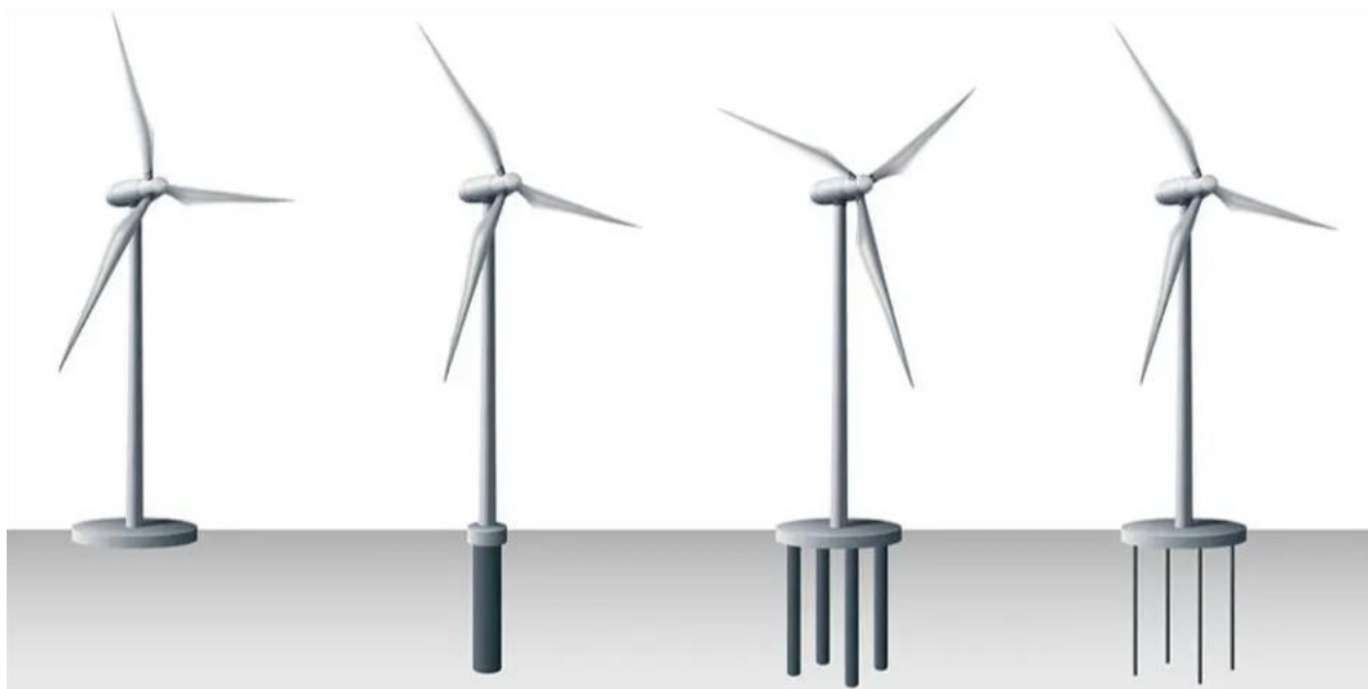
Joonis 2. Tuulikute vundamentide tüübid 4 .
