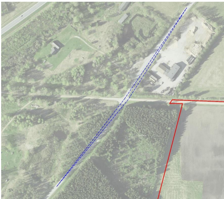
Skeem 5.5.1. Väljavõte Maa-ameti ortofotost ristmikul riigitee nr 19247 km-l 4,309 koos planeeringuala piiri (punane pidevjoon) ja ristmiku liitumisnähtavusega (sinine kriipsjoon)
