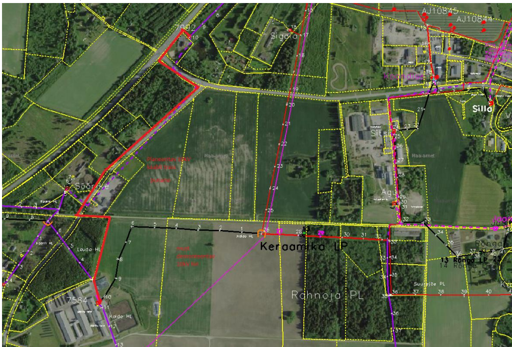
Skeem nr 5.6.4.1. Elektri õhuliini demonteerimine mastini nr 26 (must joon) ja perspektiivse 10 kV maakaabli kavandamine (punane joon) (allikas: Elektrilevi OÜ)
