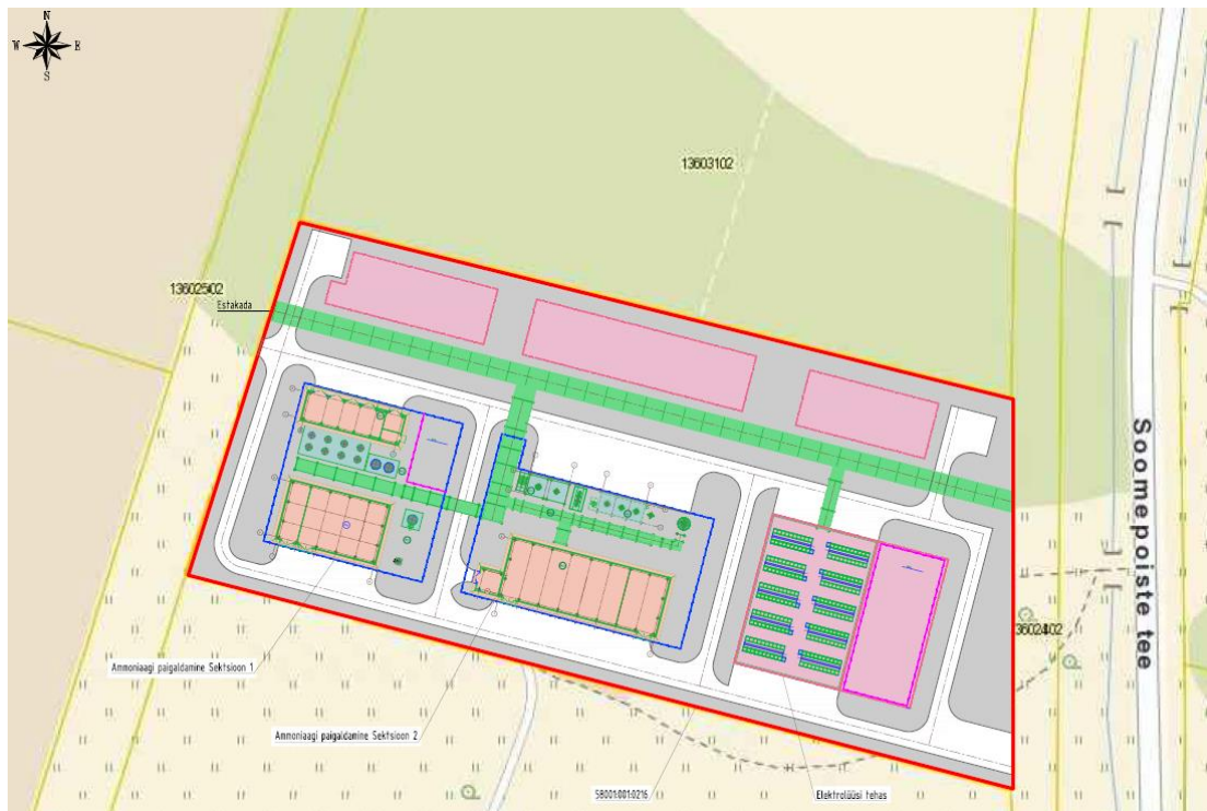
Joonis 2.1 Ammoniaagitehase tootmisüksuste paiknemine Kasesaare tee 10 (väljavõte eskiisprojektist). Ammoniaagitehase seadmed paiknevad oranžiga tähistatud piirkonnas, muud tootmisüksused ja hooned on lillaka tooniga. Rohelised on märgitud erinevate torustike estakaadid.
