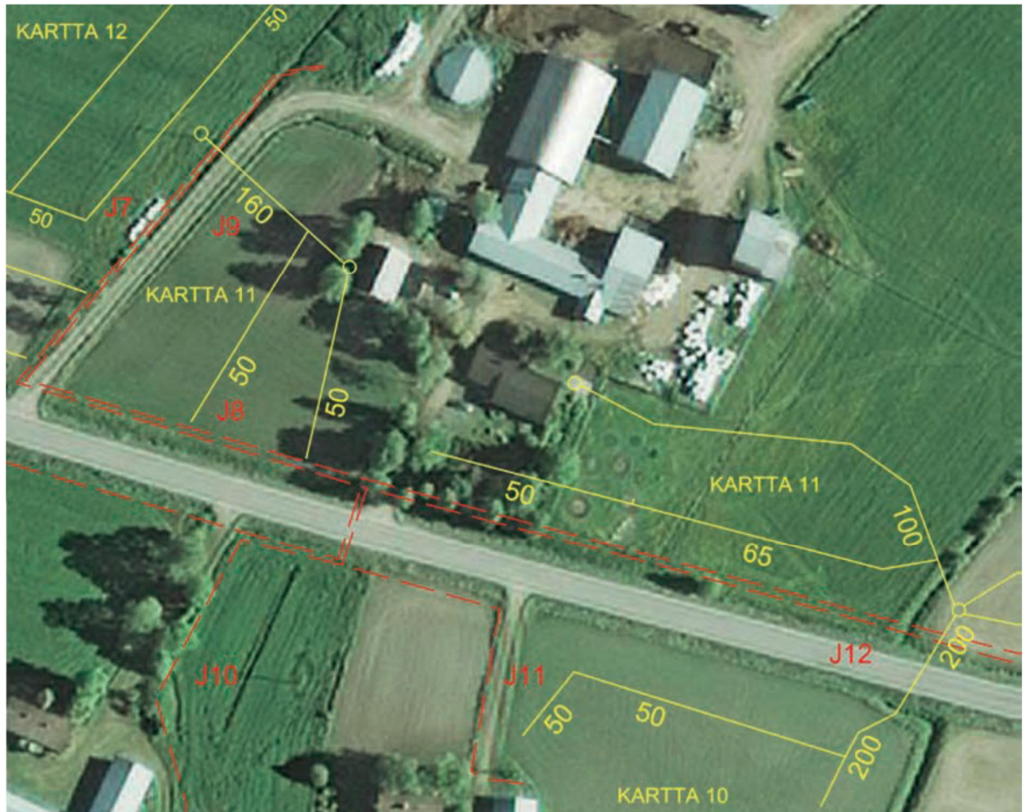
Joonis 2. Näide kuivendussüsteemi projekteeija poolt koostatud plaanist, kuhu on märgitud liinirajatise võimalikud asukohad, samuti drenaazi, kaevude jm ehitiste asukoht ja torude läbimõõdud. Kaevetööde tarbeks koostatakse eraldi plaan, kuid aerofotol näidatud drenaazisüsteemid ja liinirajatise asukoht on eriti vajalik ja informatiivne nii maaomanikule kui kaevetöid tegevatele töötajatele. Pilt: Rainer Rosendahl
