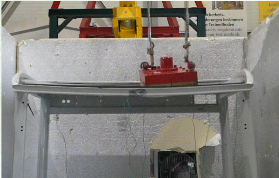
Bild / Picture 6: Zehnter Fall bei 40°C / Tenth drop at 40°C
