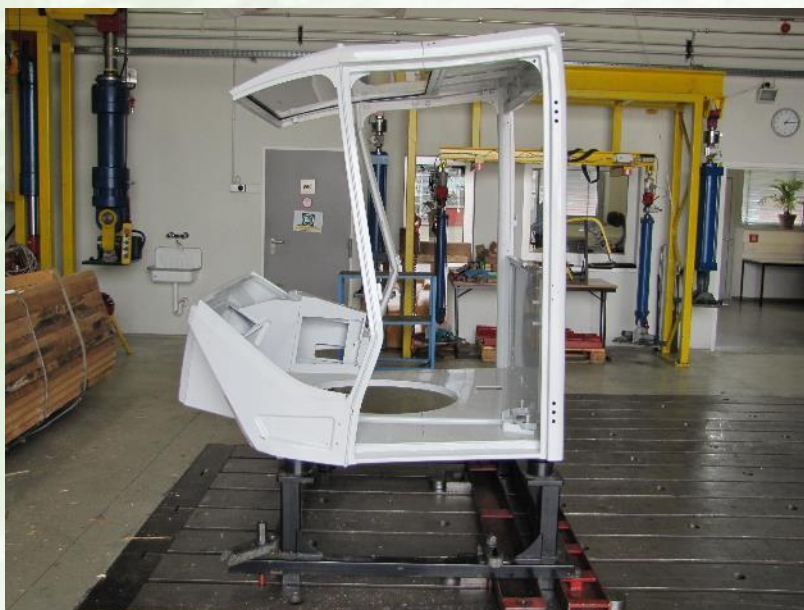
Bild / Picture 12: Nach dem Aufschlag der Prüflast, Standardkabine / After impact of test load, standard cab
