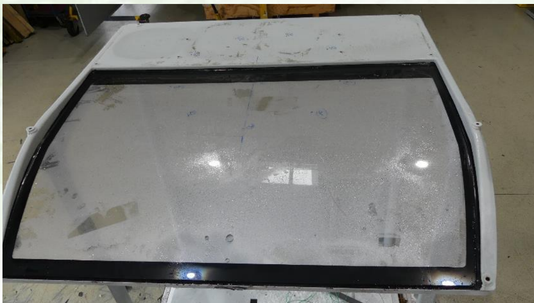
Bild / Picture 4: Oberseite nach der Prüfung bei -20°C / Top surface after the test at -20°C
