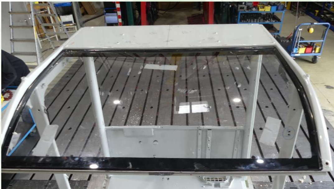
Bild / Picture 7: Oberseite nach der Prüfung bei 40°C / Top surface after the test at 40°C
