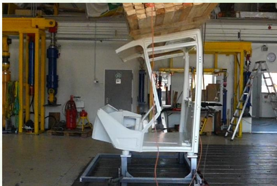
Bild / Picture 9: Aufschlag der Prüflast, Hochkabine / Impact of test load, high cab
