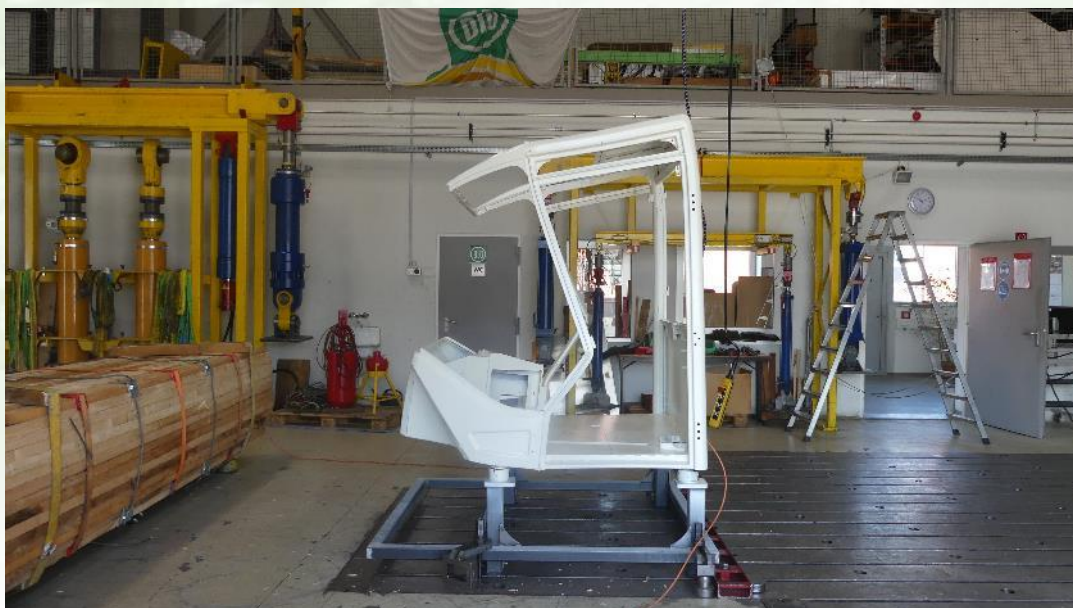
Bild / Picture 10: Nach dem Aufschlag der Prüflast, Hochkabine / After impact of test load, high cab
