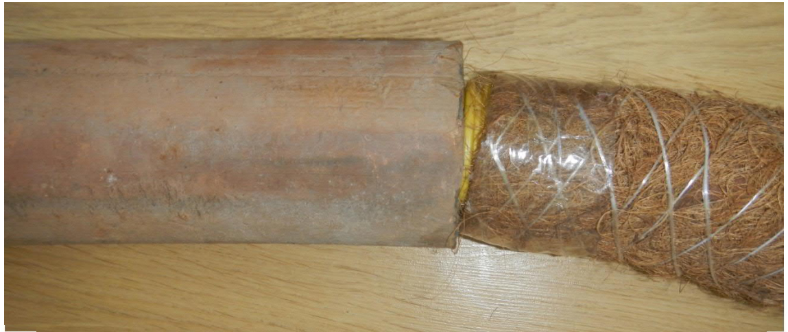
Kollektori ühendamise liugmuhviga või kaksikmuhviga De110 De110/95plast/DN75 savi
