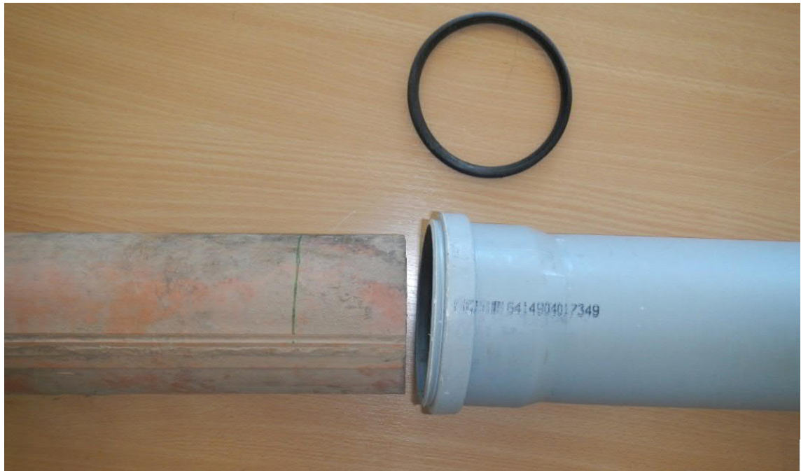
Savitoru DN75 ühendamine De110 plasttorumuhviga
