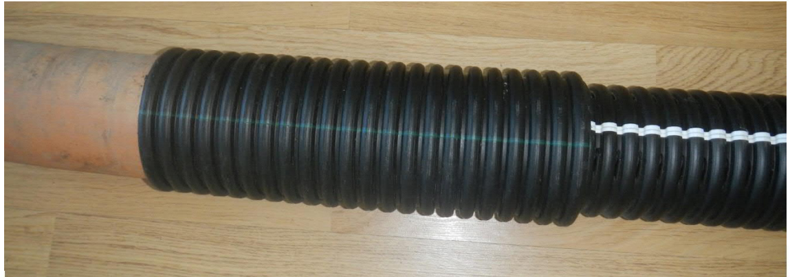
Plasttoru paigaldatud savitoru sisse DN50
