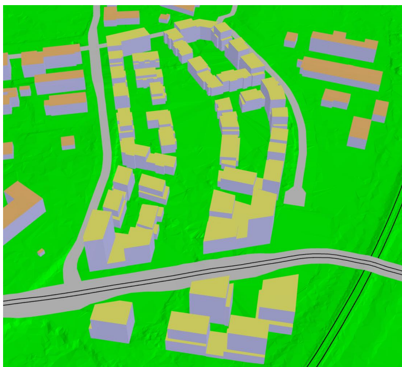
Joonis 3. Arvutustarkvara sisene 3d vaade kolmemõõtmelisest maastikumudelist
