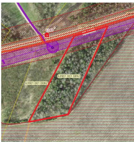
Joonis 7. Elektriõhukaabelliini, avalikult kasutatava tee ja maaparandussüsteemi põhjustatud kitsendused planeeringualal (väljavõte Maa- ja Ruumiameti kitsenduste kaardist).
