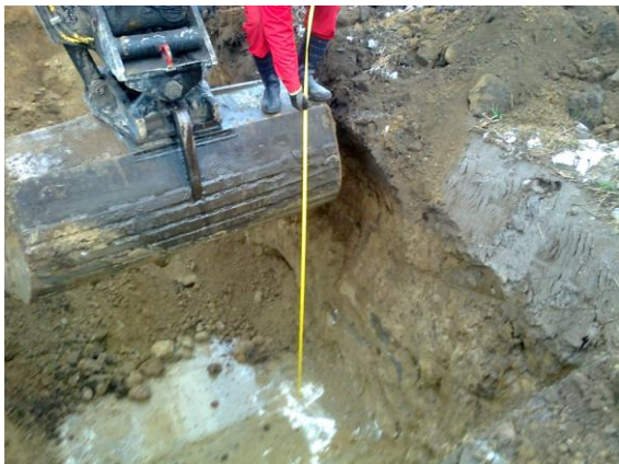
Fotod 1 ja 2. Surfid 1 ja 2, millel on näha geoloogiline läbilõige kuni paeni.
