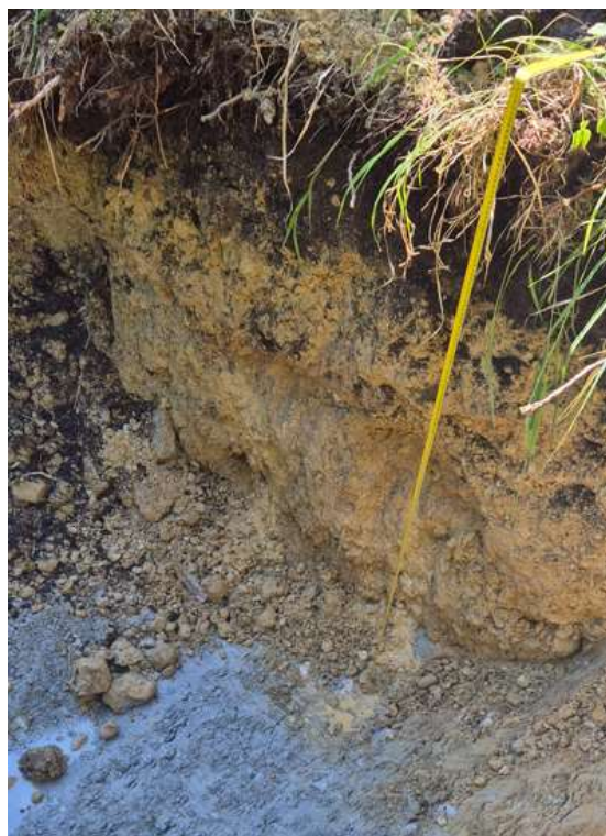
Foto 5.1. Kruusakas savitolmune liiv kaevandis K-1/25. (Foto: Sven Siir, 01.07.2025, N 58°46'43" ja E 24°45'48").
