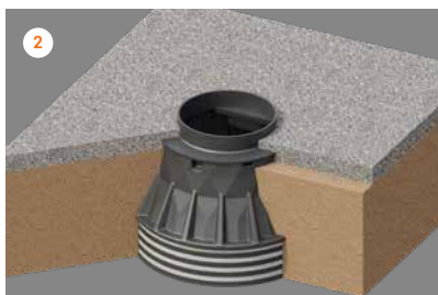
2 Lisada tihendatud killustikaluse kiht.
