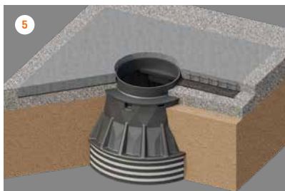
5 Lisada killustikaluse kiht koormusjaotusplaadi ümber.
