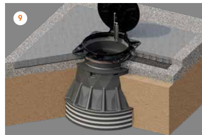
9 Paigaldamisel kontrollida luugi avanemise suunda redeli suhtes.
