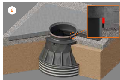
6 Paigaldada tihendusmass raudbetoonplaadi ja pumpla krae vahele.
